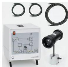
Pour déterminer la vitesse de la lumière et les indices de réfraction de liquides et de solides transparents par modulation électronique.
