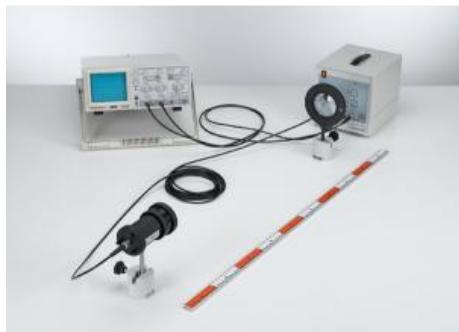
Dans l'expérience P5.6.3.1, on mesure le temps de propagation apparent en fonction de la section de mesure  $\Delta s$  et on calcule la vitesse de la lumière dans l'air selon :
