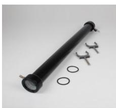
Pour la détermination exacte de l'indice de réfraction de l'eau par la mesure de la vitesse de la lumière selon le procédé de modulation ; avec deux robinets, deux colliers de serrage et deux tiges de fixation.
