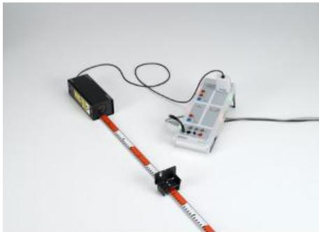
**P5.6.3.3 Détermination de la vitesse de la lumière avec un signal lumineux périodique**
