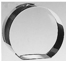
Pour déterminer l'indice de réfraction par la mesure de la vitesse de la lumière selon le procédé de modulation ; à faces polies.
