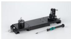
Traverse permettant de relier deux bancs d'optique parallèles. Pour la réalisation d'interféromètres, notamment de Mach-Zehnder.
