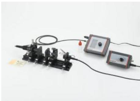
L'expérience P5.8.5.3 initie au pompage optique ainsi qu'à l'émission et à l'absorption.
