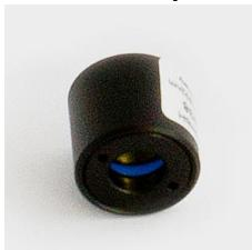
Miroir laser pour la réalisation d'un étalon Fabry-Pérot, à monter sur le support 474139 .
