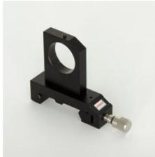
Plaque de maintien sur cavalier. Permet l'utilisation de composants optiques de 30 mm de diamètre (C30). Trois billes à ressort assurent une bonne fixation et un positionnement reproductible du composant. Les composants peuvent être utilisés d'un côté comme de l'autre, au choix.
