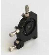
Lentille biconcave à courte focale ( $f = -5$  mm) dans support ajustable, pour élargir un faisceau laser.
