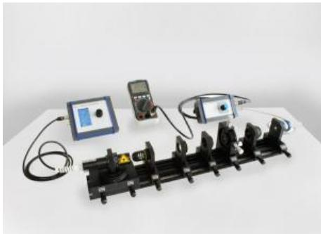
Le but de l'expérience P5.8.6.1 est d'étudier les propriétés d'une diode laser, à savoir ses paramètres caractéristiques comme la puissance et la longueur d'onde d'émission en fonction de la température.
