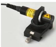
Diode laser sans autre composant optique, montée sur support tournant à l'horizontale et à la verticale pour l'étude de la distribution spatiale du rayonnement et de la polarisation d'une diode laser.
