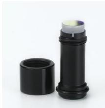
Miroir concave pour la réalisation d'un résonateur laser à 1064 nm, avec 4745310 .
