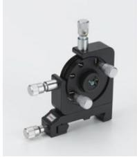
Cristal à propriétés optiques non linéaires dans support. Il permet le doublage de fréquence intra-cavité à 532 nm (vert) de la longueur d'onde infrarouge 1064 nm d'un laser Nd:YAG. Le cristal peut être basculé et déplacé respectivement sur deux axes ainsi que tourné sur l'axe longitudinal afin d'atteindre l'accord de phase. Traité antireflet des deux côtés pour 1064 nm et 532 nm.
