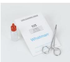
Kit de nettoyage spécial composants optiques laser, constitué de feuilles de papier non pelucheux, d'une pince moustique pour tenir le papier pendant le nettoyage et d'un flacon compte-gouttes pour le liquide de nettoyage (par ex. alcool, acétone).
