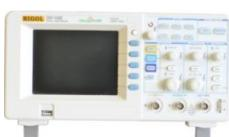
Oscilloscope numérique, opération facile à utiliser.
