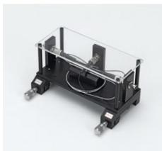
Pour mélanger deux entrées dans une fibre optique, par exemple pour l'injection commune du rayonnement de pompe (980 nm) et du signal (1550 nm) dans une fibre dopée erbium (474 189).
