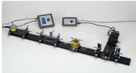
Dans l'expérience P5.8.7.1, une fibre dopée à l'erbium est utilisée comme milieu actif. Celle-ci étant connectée à un laser de pompe, on analyse la fluorescence de la fibre dopée à l'erbium. Avant d'étudier le fonctionnement du laser à 1,5 µm, on mesure la durée de vie de l'état excité.
