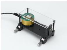
Le module contient un laser à diode intégré dans un boîtier papillon.
