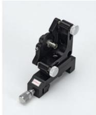
Lentille aphérique de collimation dans support ajustable.
