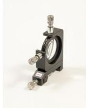
Lentille plan-convexe dans support pour faire converger les deux faisceaux en un point où se forment les franges d'interférence avec un dispositif de vélocimétrie laser à effet Doppler VLD (ou anométrie laser Doppler). La lentille est déplaçable sur deux axes à des fins d'ajustage.
