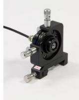
Laser à diode rouge à luminosité réglable. Le laser est décalé latéralement afin de générer avec le séparateur de faisceau 474187 deux faisceaux symétriques, par exemple pour une anémométrie laser Doppler. Dispositif d'ajustage X,Y - ?, f pour l'orientation du faisceau inclus.
