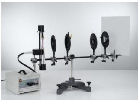
Au cours de l'expérience P6.2.1.1, une lampe de Balmer remplie de vapeur d'eau sert à l'excitation du spectre d'émission.
