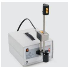
Avec douille sur tige munie d'un câble solidaire pour la fixation d'une lampe de Balmer (45113 ou 451 41) soit à l'alimentation, soit sur un banc d'optique.
