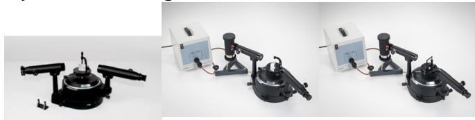
Pour observer et mesurer les spectres d'absorption et d'émission.
