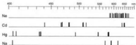
Durant l'expérience P6.2.2.1, on procède à la décomposition spectrale des spectres démission de vapeurs métalliques et de gaz rares (mercure, sodium, cadmium et néon) avec un réseau haute définition pour les projeter ensuite sur un écran afin de les comparer.
