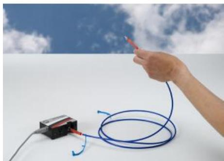
**P6.2.2.5 Enregistrement des raies de Fraunhofer à l'aide d'un spectromètre compact**
