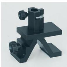
Cavalier pour banc d'optique à profil normalisé.
