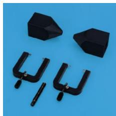
Pour réaliser un électro-aimant avec des éléments du transformateur démontable.
