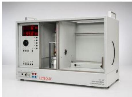
Durant l'expérience P6.3.1.1, on démontre que des rayons X peuvent traverser la matière sur l'exemple d'un objet simple dont les éléments sont constitués de matériaux avec des propriétés d'absorption différentes.
