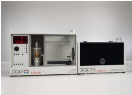
L'expérience P6.3.1.11 mesure l'atténuation des rayons X par l'évaluation quantitative d'une radiographie numérique sur ordinateur, mesure le contraste d'une radiographie numérique en fonction de l'énergie et de l'intensité des rayons X et détermine la résolution des radiographies numériques à l'aide de différentes images test.
