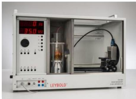
L'expérience P6.3.1.12 mesure l'atténuation des rayons X par l'évaluation quantitative d'une radiographie numérique sur ordinateur, mesure le contraste d'une radiographie numérique en fonction de l'énergie et de l'intensité des rayons X, détermine la résolution des radiographies numériques à l'aide de différentes images test et projette et mesure la tache focale de l'anode du tube à rayons X par une simple image géométrique sur le capteur de radiographie.
