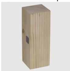
Parallélépipède en bois avec tige d'acier dissimulée pour la radioscopie dans l'appareil à rayons X.
