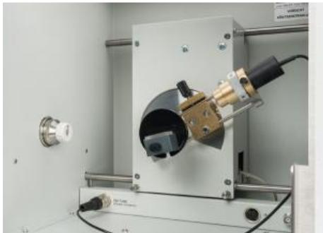
Dans l'expérience P6.3.2.3, on détermine le coefficient d'atténuation  $\bar{\lambda}(\bar{e})$  de différents matériaux d'absorption pour une longueur d'onde  $\bar{e}$  située en dehors des arêtes d'absorption.
