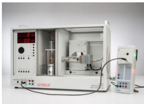
Les expériences P6.3.5.2 et P6.3.5.3 se consacrent à la mesure directe de spectres émission de deux tube à rayons X et d'anodes en cuivre ou en molybdène.
