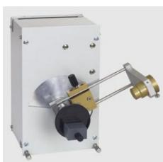
Avec deux moteurs pas à pas qui sont commandés indépendamment l'un de l'autre pour le bras de capteur et le bras de cible. Le déplacement est défini par des boutons-poussoirs de la zone de commande de l'appareil à rayons X (554 800 et 554 801) et déclenché manuellement ou automatiquement. Inclus au matériel livré avec l'appareil à rayons X (554 801).
