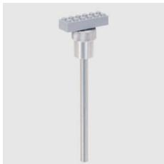
L'adaptateur LEGO® sert à fixer de petits objets LEGO au goniomètre (554 831) de l'appareil à rayons X (554 801) en vue d'enregistrer des séries d'images tomodensitométriques à l'aide du module de tomodensitométrie (554 821).
