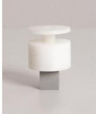
Corps d'essai pour la tomodensitométrie constitué de plusieurs couches pour l'estimation du pouvoir de résolution avec un contraste important et faible, pour la détermination de différents coefficients d'absorption (unités Hounsfield) et pour la production d'artefacts métalliques.
