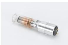
Tube à cathode chaude incandescente à chauffage direct avec filetage pour composant de refroidissement et culot à broches bipolaire pour le chauffage de la cathode convient pour l'appareil à rayons X ( 554 800 et 554 801 )
