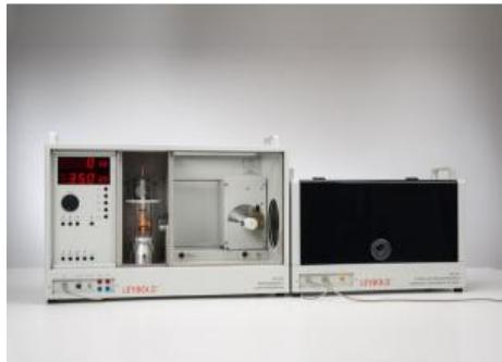
Dans l'expérience P6.3.8.4, on étudie les coefficients d'absorption de l'eau dans un corps plastique pour comprendre les possibilités offertes par la tomodensimétrie pour la différenciation des types de tissus ainsi que pour calibrer en unités Hounsfield et discuter des effets du durcissement de rayon.
