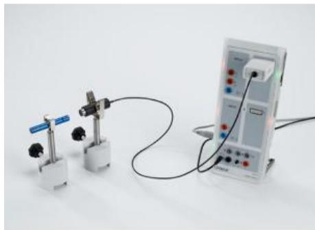
Durant l'expérience P6.4.2.1, on se sert d'un système CASSY pour déterminer à plusieurs reprises le nombre n d'impulsions qui provoque un rayonnement radioactif dans un tube compteur Geiger-Müller pendant un intervalle de temps  $\Delta t$  au choix.
