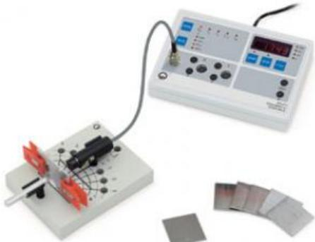
Dans l'expérience P6.4.4.4, on étudie latténuation dun rayonnement à au passage dans de la matière. Ici aussi, l'intensité diminue quasiment de façon exponentielle.
