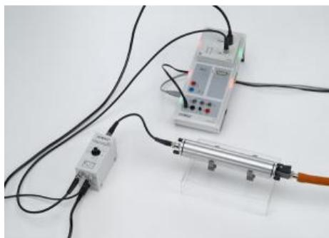
Au cours de l'expérience P6.5.4.2, on mesure l'énergie E de particules α en fonction de la pression p de l'air dans la chambre à vide.
