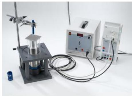
Dans l'expérience P6.5.5.3, on mesure latténuation dun rayonnement  $\gamma$  dans différents absorbeurs. L'objet de l'étude est l'influence du matériau d'absorption et de l'énergie  $\gamma$  sur le coefficient d'atténuation  $\mu$ .
