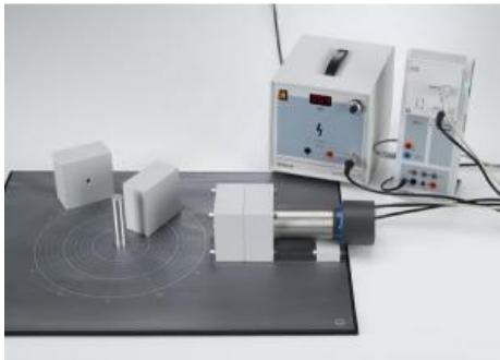
Durant l'expérience P6.5.6.1, on étudie la diffusion Compton de quanta à dénergie  $E_0 = 667$  keV sur les électrons quasiment libres dun diffuseur en aluminium.
