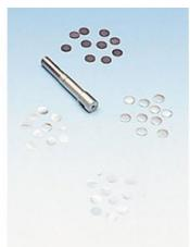
Permet de fixer des préparations radioactives sur une tige de 4 mm, de concentrer le faisceau de rayons ainsi que de l'atténuer par des absorbeurs d'aluminium et de plomb d'épaisseur variable. Avec deux perçages de 4 mm, diaphragme et capuchon servant de support pour diaphragme et absorbeur. Livré avec 40 pastilles d'absorption.
