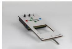
Pour la connexion et l'alimentation des divers cristaux de germanium sur carte imprimée, avec tige pour le montage de l'appareil entre les pièces polaires du transformateur démontable.
