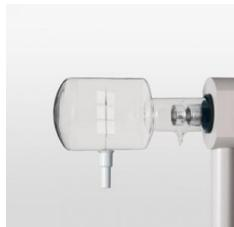
Pour la démonstration de l'excitation de l'émission de la lumière pendant et après un bombardement par électrons ou par rayonnement UV.
